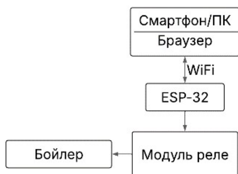
Рисунок 3 – Структурна схема системи програмного управління побутовим електричним бойлером
