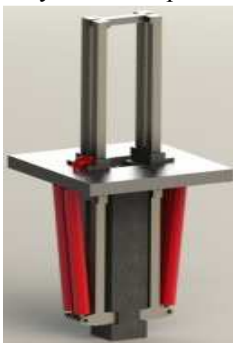
Рис. 3. Загальний вигляд розробленого нового гідродомкратного пристрою – вантажопідйомного крокуючого модулю ВПКМ [6]
