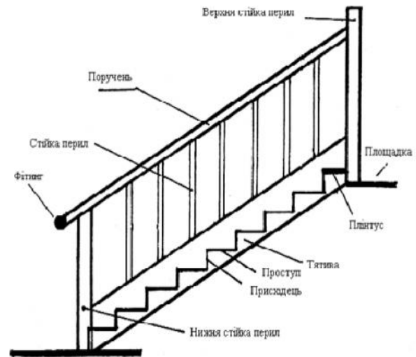
Рис. 15. Загальний вигляд сходів та їх основні елементи
