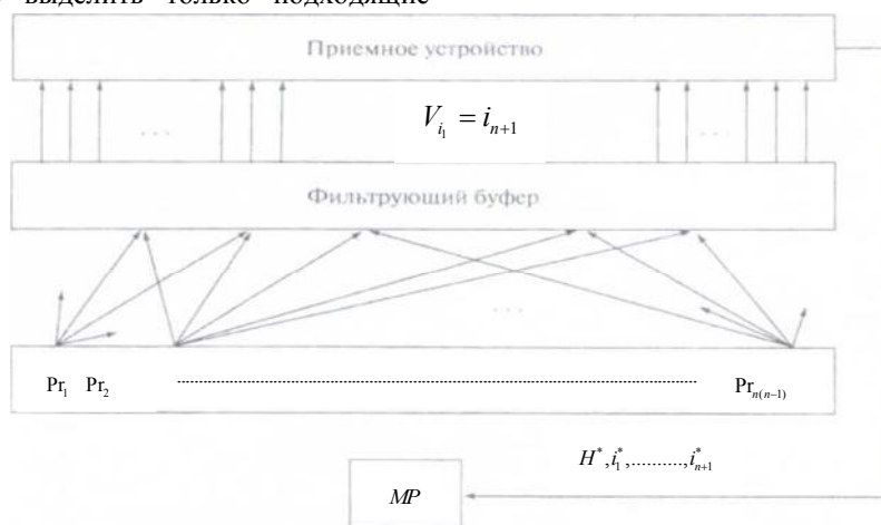
Рис. 3. Модель многоуровневой глобальной вычислительной архитектуры с фильтрующим буфером и принимающим устройством
