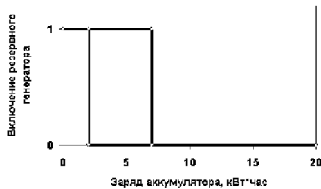
Рис. 7 Регулировочная характеристика включения резервного генератора
