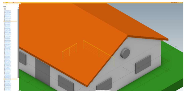
Рисунок 11 – Візуальна перевірка зв'язку між IfcRailing та IfcWall (GlobalId: 0o5vgCKyTBzO5$QJcI2YDP та GlobalId: 2XPYKWY018sAlygZKgQPtU)
