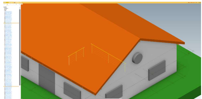
Рисунок 10 – Візуальна перевірка зв'язку між двома елементами IfcRailing (GlobalId: 0o5vgCKyTBzO5$QJcI2YDP та GlobalId: 09axaKU7X1_O8n6dmmiZIE)
