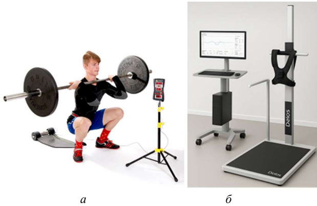
Рисунок – Приклади реалізованих комплексів для розпізнавання фізичних вправ: а – апаратно-програмний комплекс експрес-аналізу важкоатлетичних вправ Weightlifting analyzer 3.0; б – стабілографічний комплекс Delos Postural System
