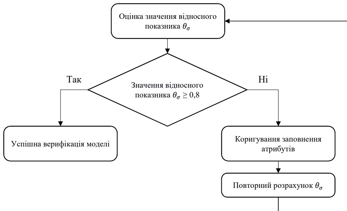
Рисунок 3 – Алгоритм оцінки значення показника якості BIM-моделі
