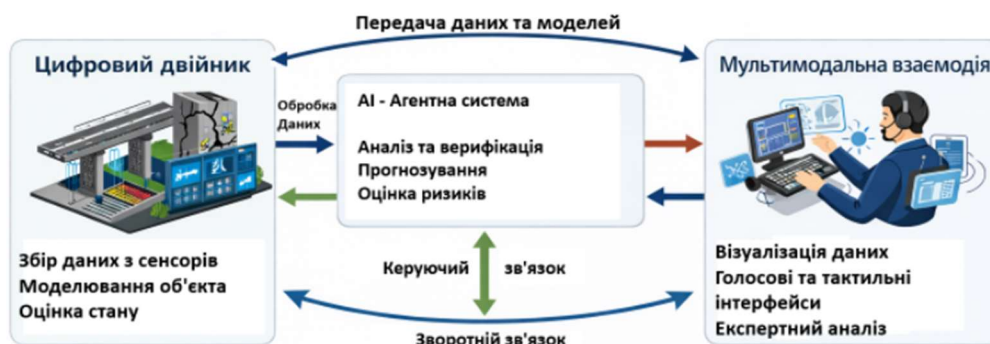
Рисунок 2 - Концептуальна архітектура інтегрованої системи моніторингу та динамічної верифікації цифрових двійників пошкоджених об'єктів інфраструктури
