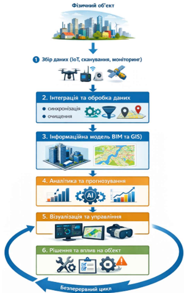
Рисунок 1 – Узагальнена структурно-функціональна схема створення цифрового двійника інфраструктурного об'єкта
